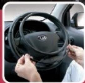
Muito fácil de usar, o anel eletrônico de aceleração KS pode ser removido do volante sem deixar quaisquer vestígios, permitindo assim libertar mais espaço entre o volante e o condutor, caso necessite carregar a cadeira de rodas. A possibilidade de remoção facilita a utilização por outro condutor sem deficiência motora. Para acelerar basta uma ligeira pressão sobre o anel.
